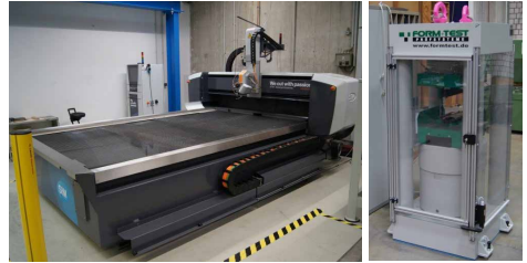
Bild 2: Wasserstrahlchneidanlage (links) und 5000 kN-Druckprüfmaschine (rechts)
