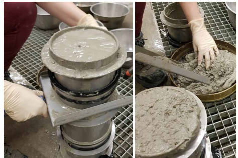
Bild 3: Auswaschversuch: Teilen des dreiteiligen Sedimentationstopfes (links), Auswaschen auf einem 4 mm Sieb (rechts)
