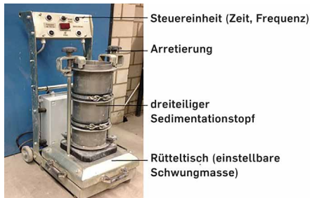
Bild 1: Rütteltisch – Prototyp mit variabler Regelung der Verdichtungsparameter
