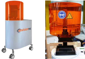
Bild 2: 3D-Drucker: mobiles Gerätegehäuse (links), ultraviolettfilternde Schutzhaube, Materialwanne und Verfah- sowie Belichtungseinrichtung (rechts)
