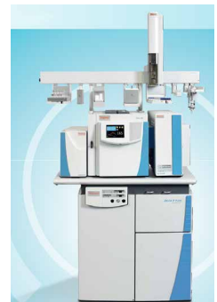
Bild 2: Gaschromatograph-Isotopenverhältnis-Massenspektrometer der Firma Thermo Fisher Scientific
