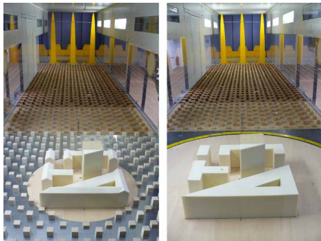
Bild 2: Blick gegen die Windrichtung auf das eingebaute Modell; links: Gebäude mit Spitzdachvariante und mit Rauigkeiten in direkter Gebäudenähe; rechts: Flachdachvariante ohne Umgebungsrauigkeiten
