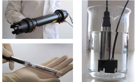
Bild 2: Messsonden zur Untersuchung der biochemischen Umsatzprozesse: Ammonium und Nitrat (oben links), Lachgas (unten links), Sauerstoff (rechts)
