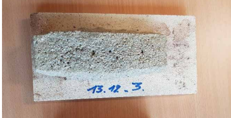
Bild 2: Probekörper nach Temperaturbeaufschlagung
