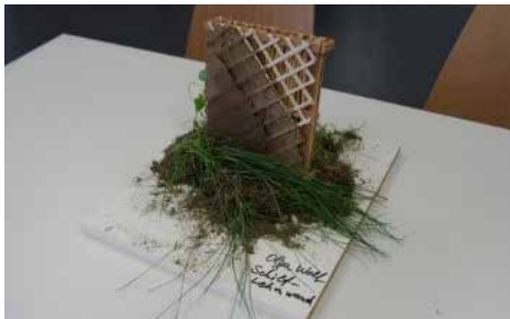
Bild 7: Modellprojekt Tiny House Village in Minden als Reallabor für unterschiedliche Bauweisen – Schilf-Lehm-Wand
