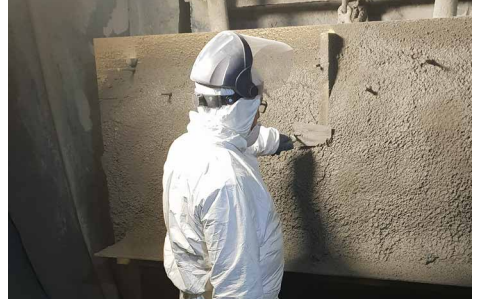
Bild 3: Spritzbetonapplikation im Spritzbetonversuchsstand
